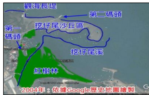
1994~2004年台北港興建，突堤效應加速淤積
