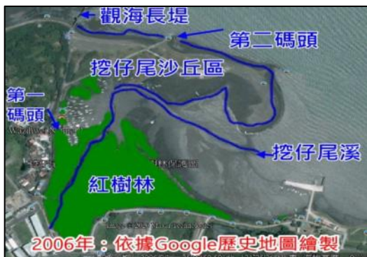
2004~2006年台北港興建，突堤效應加速淤積
