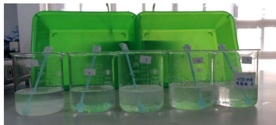
圖 2.不同種類的 PVA 顆粒無法在常溫下溶解於水中
