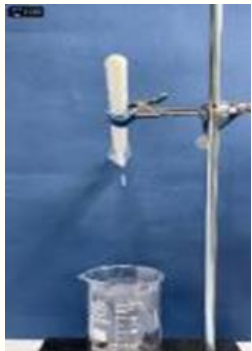
圖8無添加甘油果凍塑膠的密封性
