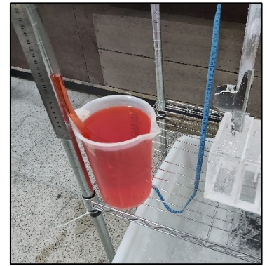
圖 8-22 注氣管另一端放入紅色液體中，測量液體上升高度
