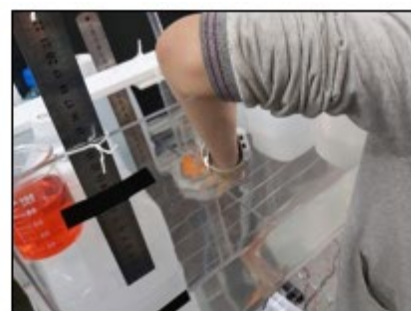
圖 7-9 緊壓油土，防止漏水
