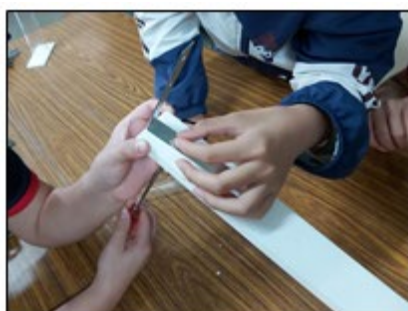
圖 7-7 使用螺絲固定虹吸鐘支架
