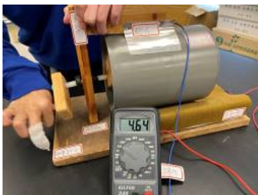
圖 5-2-8 「手動型」靜電產生器成功產生靜電
