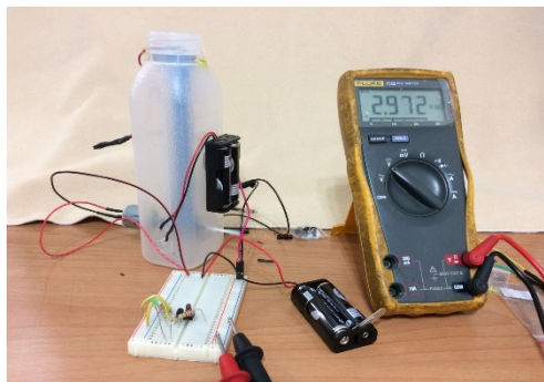
圖 6-3 靜電產生器的電荷存入到電容內。
