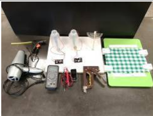
圖 3-2-1 三用電表、電線、PVC 管、空氣品質檢測器、手動靜電摩擦起電裝置、自製風力量角器、釘槍、吹風機、熱熔膠槍、熱熔膠條、隔板、螺絲起子、電池。
