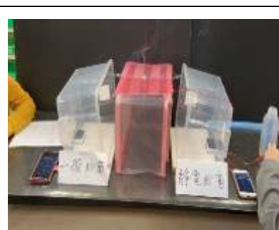
圖 4-3-45 比較有無靜電紗窗阻隔線香的效果
