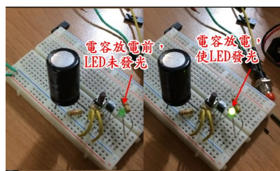
圖 6-4 電容放電驅動電晶體使 LED 迴路導通而發光，直到電容放電到沒電，LED 迴路關閉之後 LED 即不發光了。
