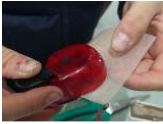
圖 31：使用直徑 4mm 打孔機做出圓形薄片。
