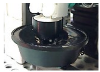
圖 26：收發一體下方放反射板才能懸浮，懸浮高度小於 5mm。
