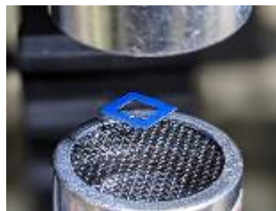
圖 35：使用雷射機切割各種尺寸色紙進行實驗 圖 36：正方形色紙最大只能承受邊長 5.5mm。 圖 37：邊框過細懸浮效果差，最佳是 1mm 圖 38：色紙挖洞後，可承受邊長變大為 9mm。
