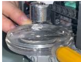
圖 29：使用塑膠凹透鏡效果好又安全。
