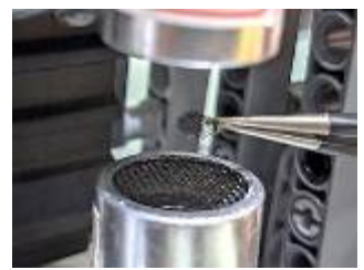
圖 34：網狀結構無法懸浮(例如鐵絲、紗窗)
