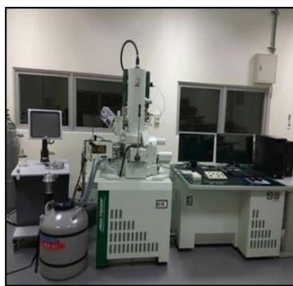
掃描式電子顯微鏡(SEM)
