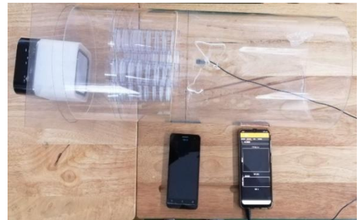
圖二十八、組合式結構(fano 型結構)實驗裝置圖
