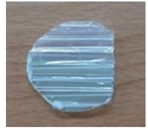
圖二十三、交錯式結構(共振結構)
