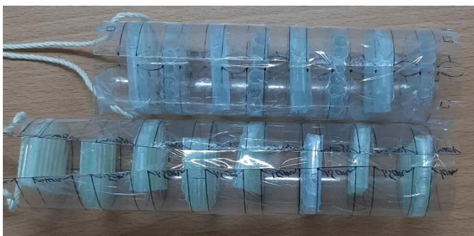
圖十七、交錯式吸管結構(共振結構)
