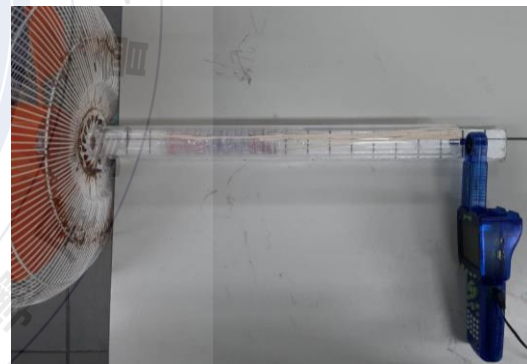
圖九、氣流穿透實驗裝置圖
