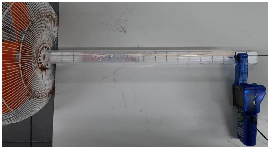
圖十九、測量結構透氣度實驗裝置
