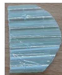
圖十七、交錯式吸管結構(共振結構)
