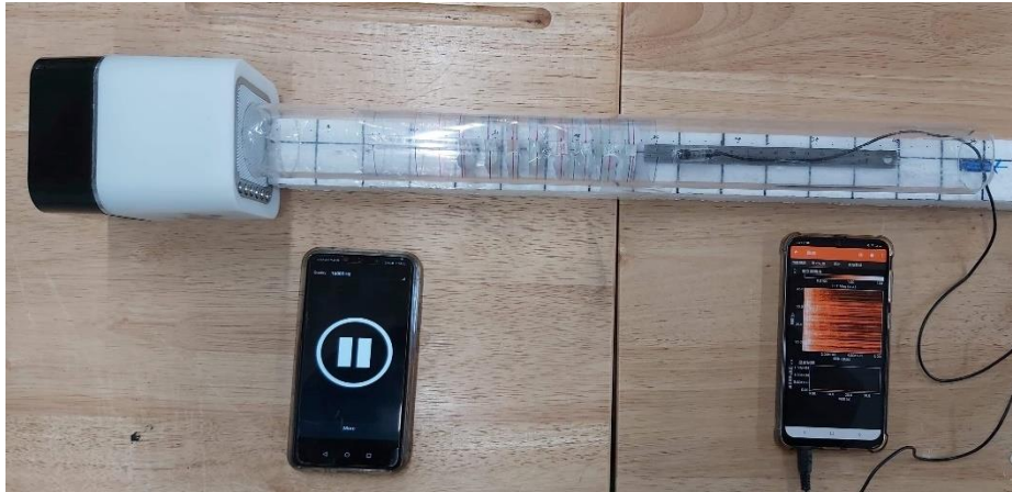
圖十五、交錯式排列(共振結構)裝置
