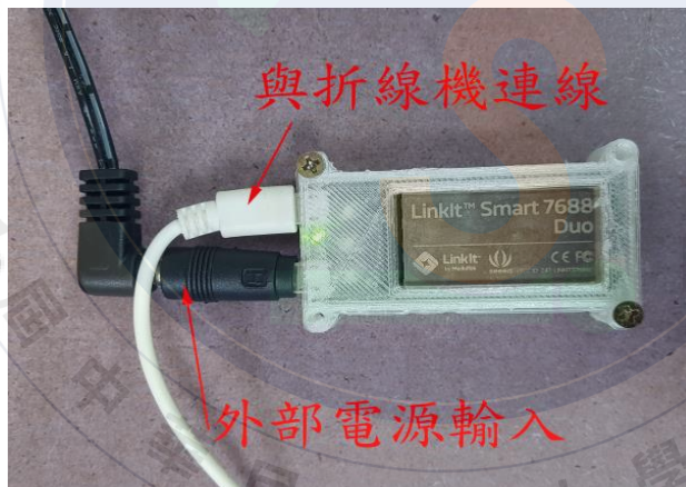
MT7688用USB 控制Arduino
