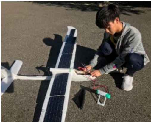
圖廿三、飛行前太陽能系統電壓量測 (圖片來源：自行拍攝)
