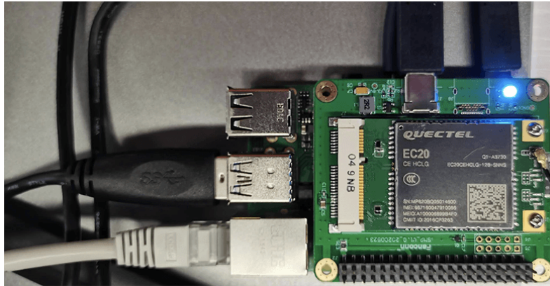
圖十一、樹梅派連結 4G LTE 搭建（圖片來源：自行拍攝）
