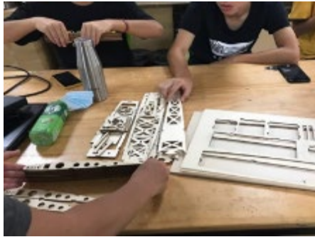
圖三、機身雷射切割 (圖片來源：自行拍攝)
