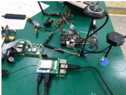
圖九、飛控及應用微處理機搭建 (圖片來源：自行拍攝)
