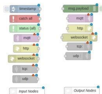
圖(二十)Node-Red 輸入輸出節點
