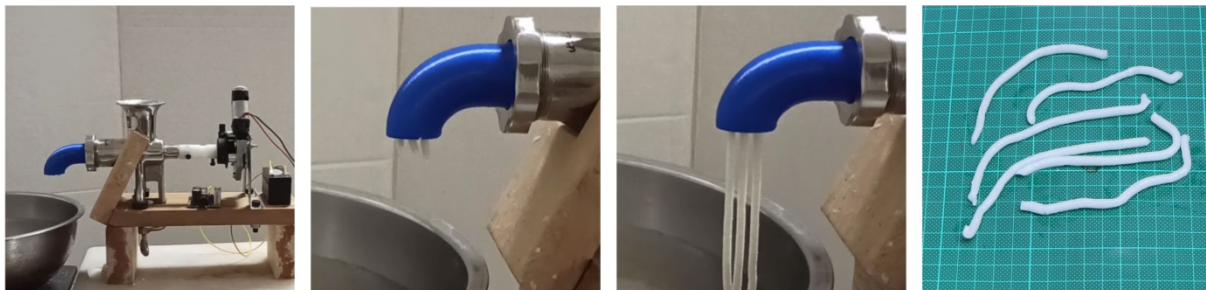
A.加裝自動進料機構B.米苔目出料順暢C.成品不會互相黏著D.外觀佳且均勻一致
