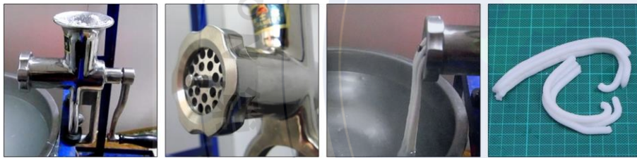
絞肉機螺旋擠壓 絞肉機出料模口 螺旋擠壓米苔目 米苔目互相黏著 手動螺旋擠壓製作米苔目
