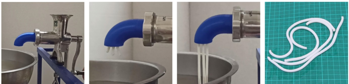
A.鉛直方向出料模口B.米苔目出料順暢C.成品不會互相黏著D.外觀佳且均勻一致
