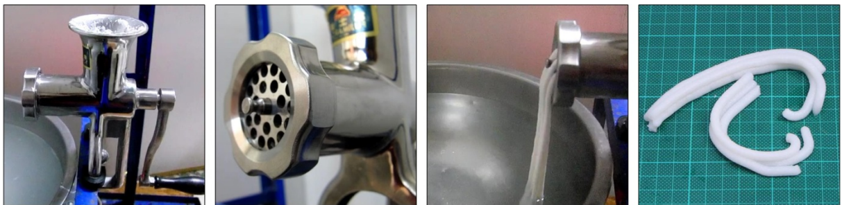
A.絞肉機螺旋擠壓 B.絞肉機出料模口 C.螺旋擠壓米苔目 D.米苔目互相黏著
