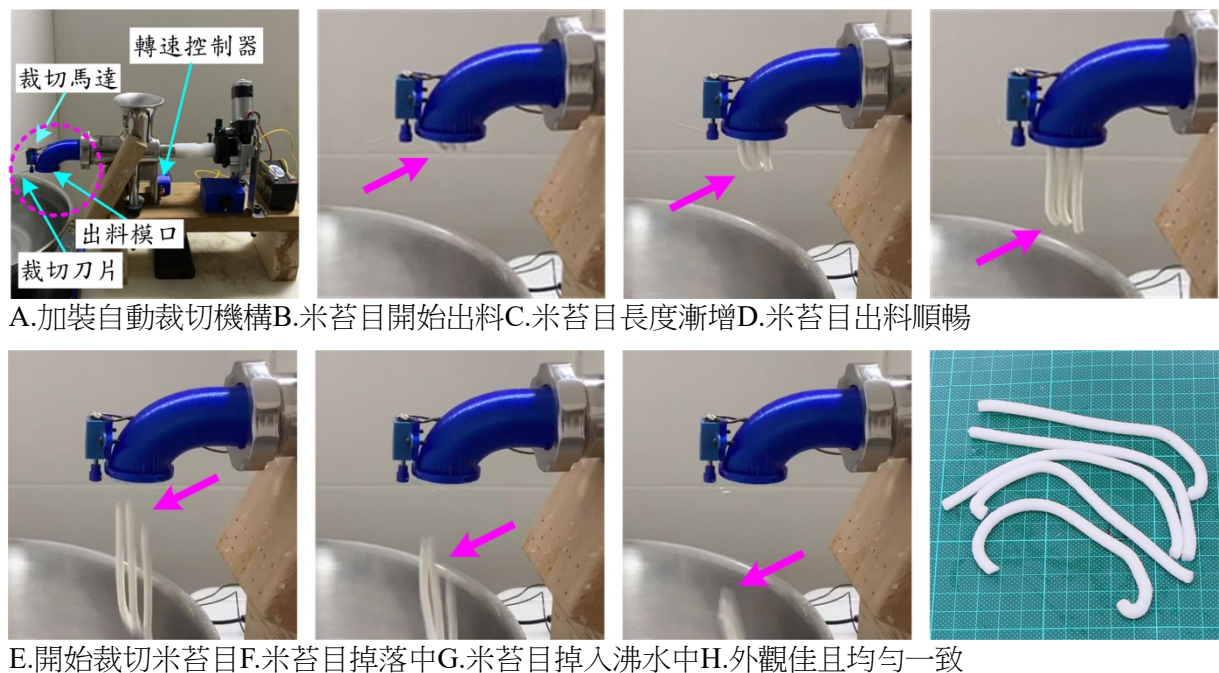
圖 19. 自動化裁切米苔目之測試
