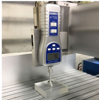
A.自製物性測定儀 B.推拉力計+D24mm 探頭 C.測試得到「時間-力」關係圖
