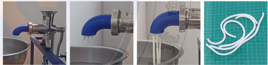
鉛直方向出料模口 米苔目出料順暢 成品不會互相黏著 外觀佳且均勻一致 手動螺旋擠壓製作米苔目之測試（鉛直方向出料模口）
