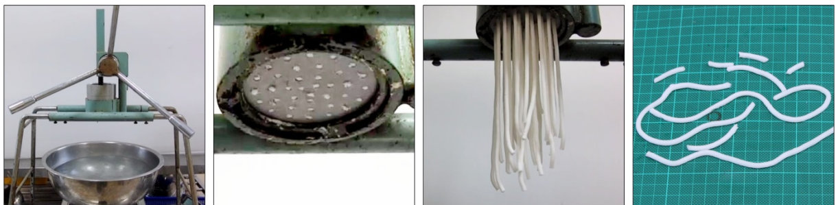
A.手動米苔目機器 B.米苔目機器之篩孔 C.擠壓米苔目之過程 D.米苔目成品
