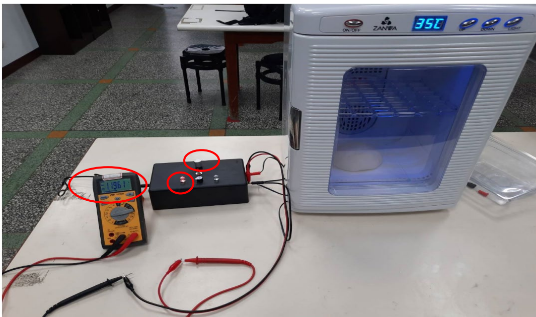
圖 21. 到達發酵定位裝置顯示燈號(紅燈)且蜂鳴器發出聲音及電表測試電壓(1.1961V)
