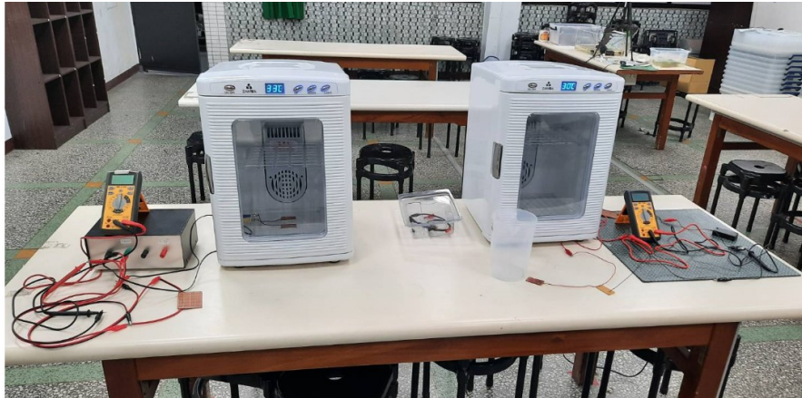
圖 14. 間接測量整體測試系統(左平面、右杯子各一套)
