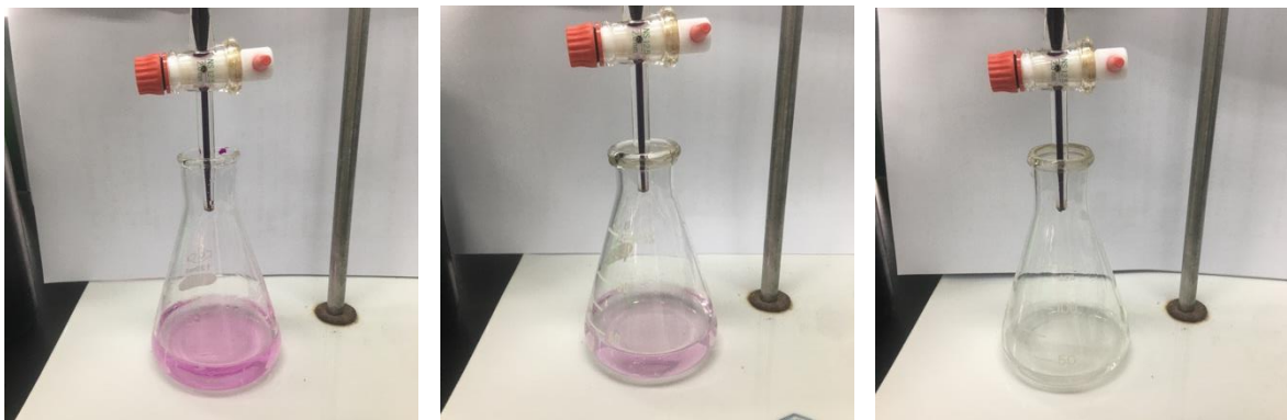
圖 5-1 氧化還原滴定實驗顏色變化示意圖(由左至右： 10^{-3} \sim 10^{-5} M NO_2^-(aq) )
