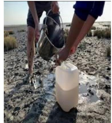
圖 11 不鏽鋼水桶為採水器，將海水倒入採水桶中
