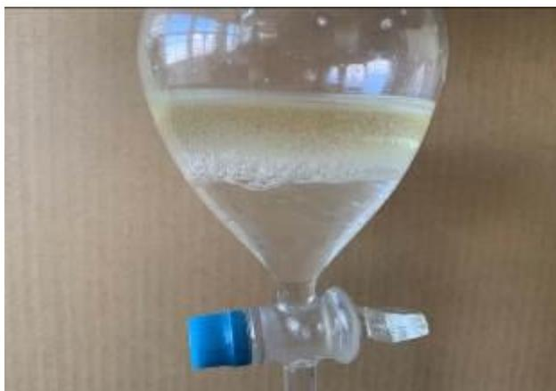
圖 31 加入食用油後，可以明顯看出微塑膠被包覆在油層
