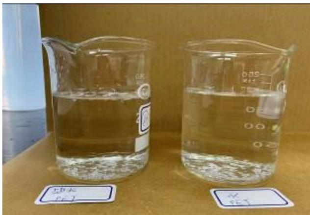
圖30 左杯為鹽水，右杯為純水，可清楚看出左杯上層的塑膠微粒較多
