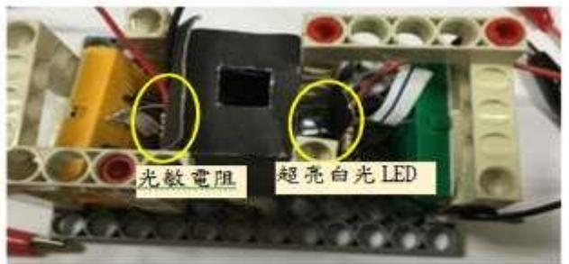
今年我們以智高積木及自製暗箱盒縮小體積如右圖，加連接線、固定槽及檔板設計，使用舊型數字型電錶內電池串接模式，設計出六段式整流變壓 3V 下，未照光的背景電壓的只有 0.01V，而六段式整流變壓未負載
