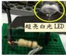
白光照在 2.38K Ω 10mm 光敏電阻與 120 Ω 電阻串聯在麵包板上
