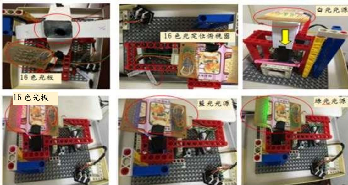
問題是，單顆 LED 燈的光區面積很好設計，但光區面積為 3\*3 cm 大小、而且每顆 LED 燈光源發射角度為 30° 角的光源，要集中光區至穿透比色管槽，讓光敏電阻感光，讓我們修正了多次後，終於設計出配合長方型光路徑箱的十六顆 LED 燈的集光器，為了修正及縮短吸光儀的長度，我們又特別設計成 L 型的第三代色光光敏電阻吸光儀，同時可以整合手機 App 辨色的第二代在暗箱光路徑區中測比色槽溶液的 RGB 大小。
