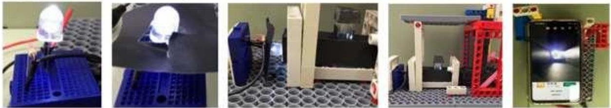
超強白光 LED 為光源 以黑色紙做遮罩 光源照射比色管槽黑色路徑 光透過 45° 平面鏡反射至上方手機鏡頭
