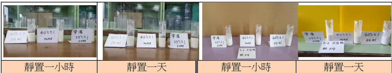
圖 3-1 濃度 3:2 玉米粉漿攪拌後靜置狀態
