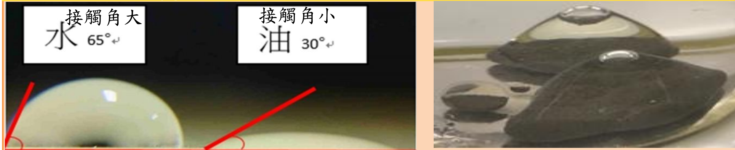
圖10 油珠和水珠與塑膠的接觸角
