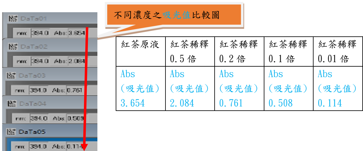
[圖 6]U-5100 分光光度計檢測紅茶吸光值曲線圖
