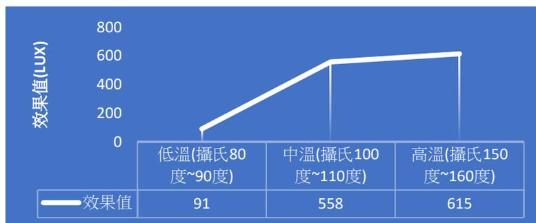
圖 11. 不同溫度轉印壓燙圖案效果折線圖(單位：LUX)
