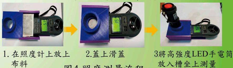
圖4. 照度測量流程
