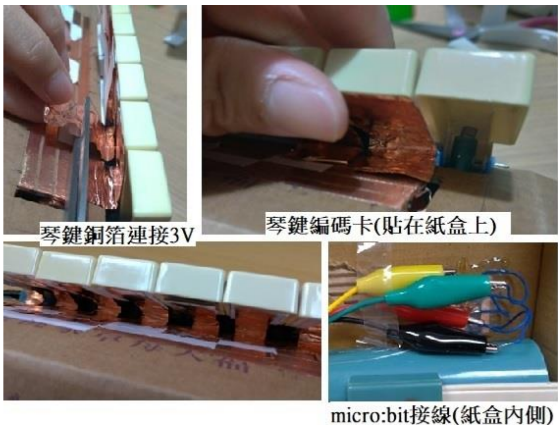
【圖 16】塑膠琴鍵與導電材質結合—利用銅箔連接
