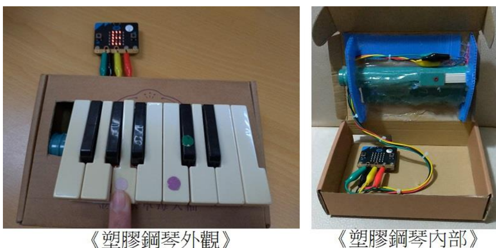
【圖 17】 塑膠琴鍵與導電材質結合一利用銅箔連接之內部構造
