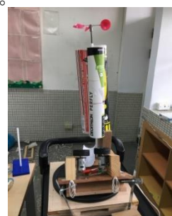
10.為了能讓寶特瓶能在球筒內上下移動，我們必須讓馬達能正反轉，我們還準備好遙控車的面版及六腳三檔開關。但是隨著試射結果不佳而石沉大海。
