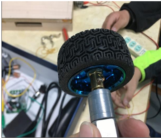
將輪胎改成有連結器的車輪組防止飛走
