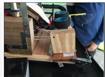
利用長木條製作滑軌。可以無段調整式調整發射角度。
