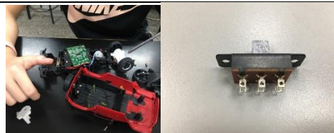
10.為了能讓寶特瓶能在球筒內上下移動，我們必須讓馬達能正反轉，我們還準備好遙控車的面版及六腳三檔開關。但是隨著試射結果不佳而石沉大海。
