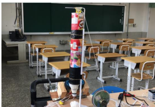
7.將洋芋片筒加裝在 L 型支架教具上。並在正上方加裝定滑輪。讓裝水的寶特瓶可以慢慢下滑推動羽球。
