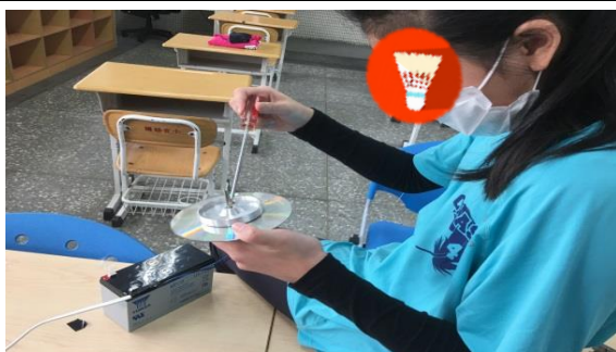
5.利用廢光碟及圓形馬達聯軸器為寶特瓶推球器加裝機動裝置。
