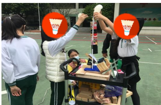
9.發現一筒球大約可裝 15 顆羽球，自動發球裝置大約 35 秒就把球發完，我們必須要上移保特瓶才能重新裝球，十分麻煩。試打同學都等到不耐煩了。如果只發 15 球，這裝置還算不錯，但是練習不夠是不能接受，我們得再找其他方法。
