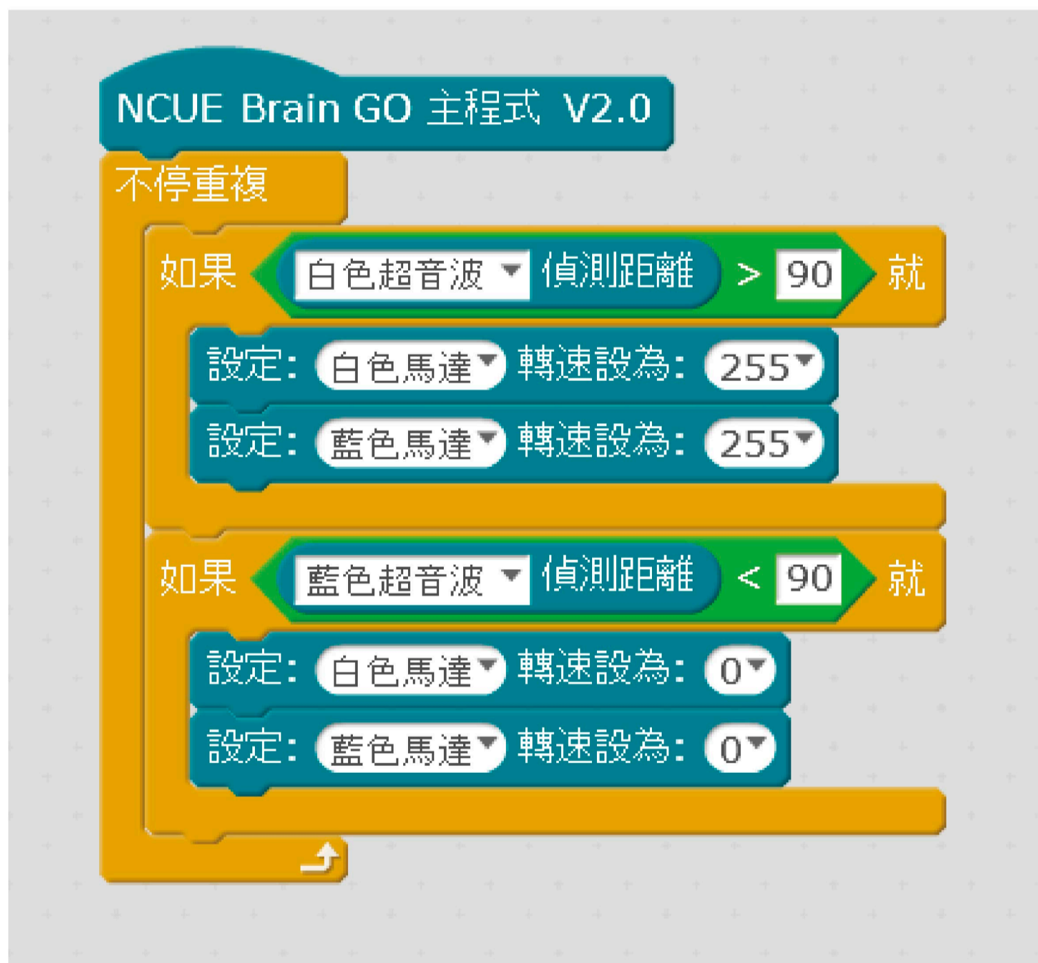
圖22. 設定一個超音波偵測，<90公分就要停止。
