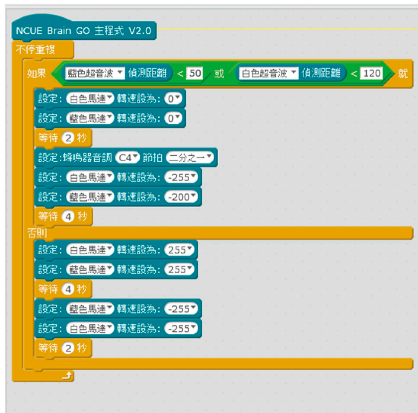
圖24. 為解決草太密集不好割斷的問題，設計直線前進4秒後，後退2秒，將草再次割除，並加入蜂鳴器作為警示。
