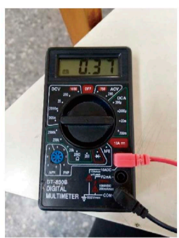
圖12. 測馬達空轉電流
