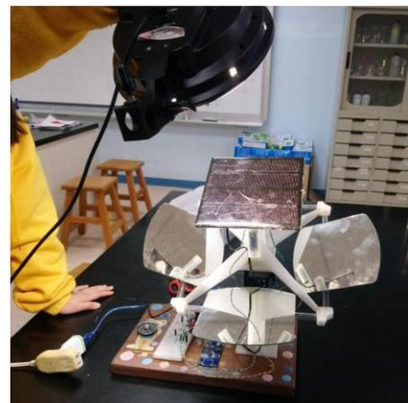
第二代雙面太陽能電池結構上有許多改變，由原本的支撐柱改成太陽能板四角支撐架，使底面太陽能板之光反射區無遮蔽物，完成圖及戶外運作如下圖：
