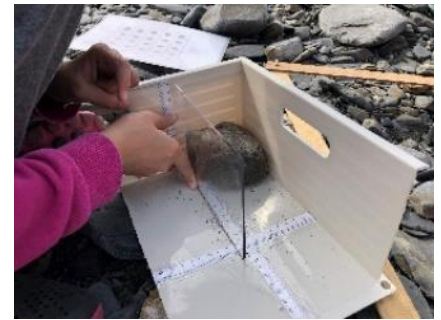
▲圖 8 使用自製礫石測量盒，測量礫石 A、B、C 三個軸的長度
