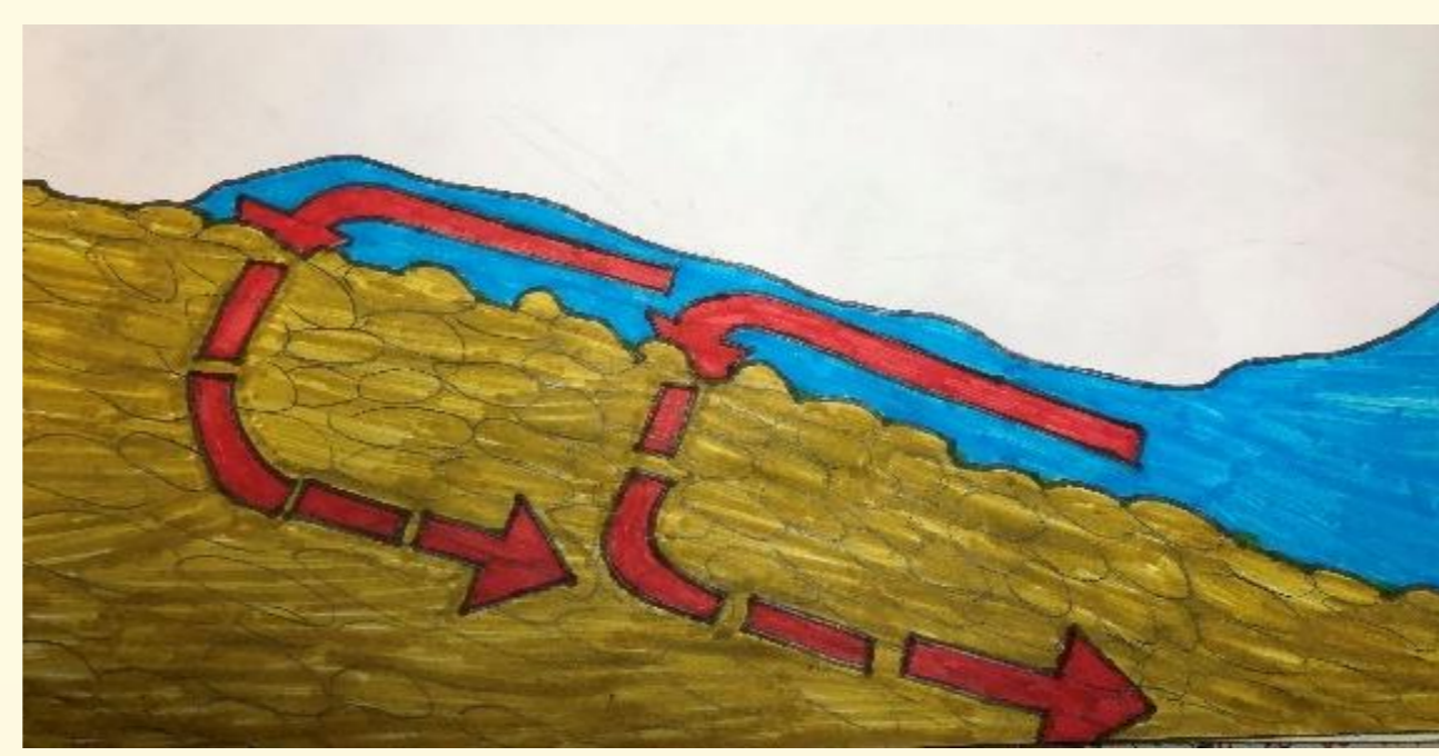
▲圖19 回流的時候，部分海水會下滲到礫石間的縫隙裡
