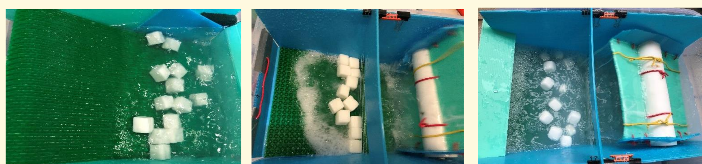
▲圖8 模擬礫石在河床上磨蝕的試驗 ▲圖9 模擬礫石在海灘上磨蝕的試驗 (水量少，模擬小浪) ▲圖10 模擬礫石在海灘上磨蝕的試驗 (水量多，模擬大浪)
