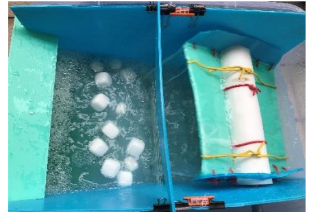
▲圖 21 模擬礫石在海灘上磨蝕的試驗(水量多，模擬大浪)
