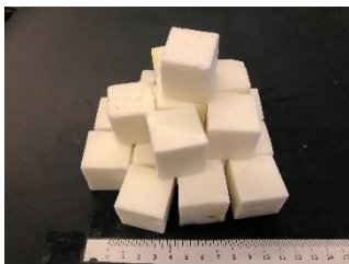
▲圖 17 模擬礫石的肥皂 (邊長 3 公分的正方體)
