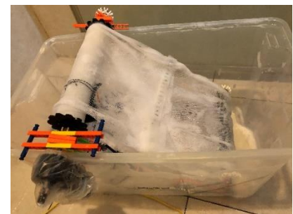
▲圖 12 最早利用積木加上紗網來設計模擬河床磨蝕礫石的設備
