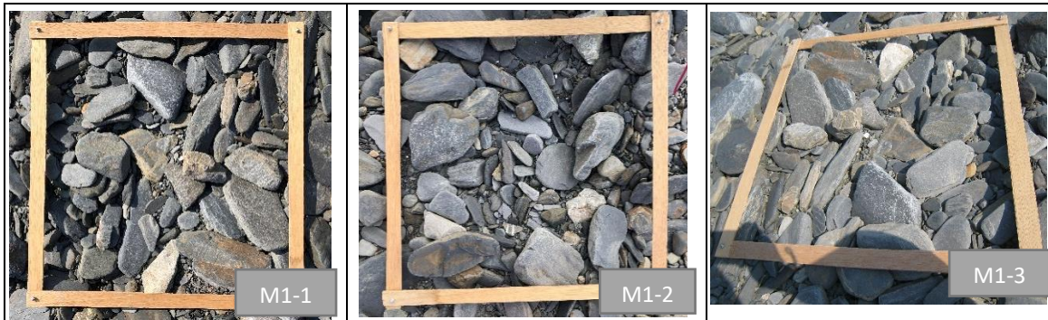
▲圖 22 羅東溪(M1-1~M1-3)的礫石球度較高，圓度較低。
