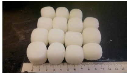
▲圖 18 經過河床磨蝕試驗圓度增加的肥皂
