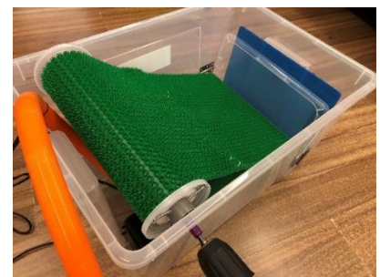
▲圖 13 使用止滑地墊改良製作模擬河床磨蝕礫石的設備
