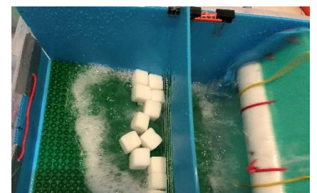
▲圖 20 模擬礫石在海灘上磨蝕的試驗(水量少，模擬小浪)
