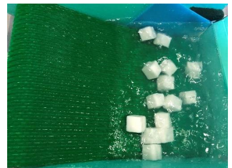
▲圖 16 模擬礫石在河床上磨蝕的試驗
