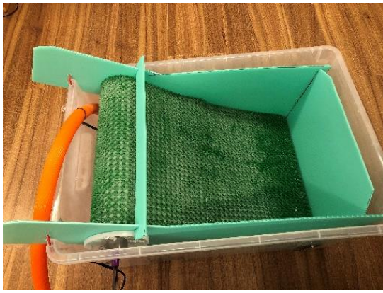
▲圖 14 河床礫石磨蝕模擬設備製作完成
