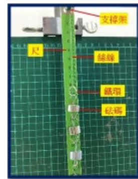
自製透氣性測試裝置圖示
