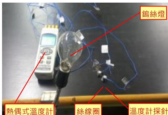
自製保溫性測試裝置圖示
