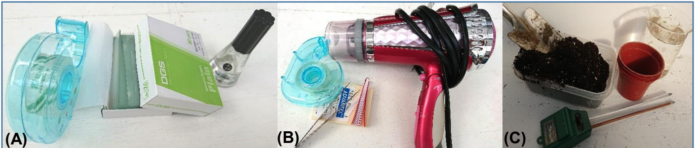
圖五、實驗器材 (A)玻片製作用，(B)蒸散測量用，(C)栽植作物及土壤溼度測試用。
