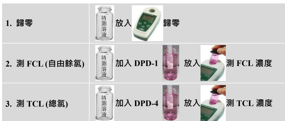
圖 7 總氯餘氯測試計 FTC-420 檢測步驟
