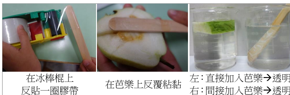
圖 13 實驗物質間接加入自來水的做法
