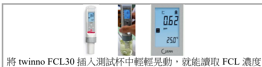
圖 9 餘氯測試計 twinno FCL30
