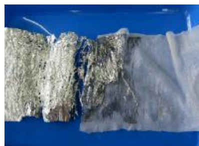
圖三十二 運轉 210 分鐘後的鋁箔上布滿被侵蝕的孔洞
