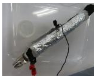
圖三十 鋁空氣電池平放，一端棉線接著鹽水
