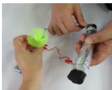
圖九 備長炭 A 製成的鋁空氣電池能夠讓風扇馬達運轉起來
