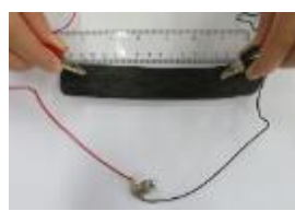
圖七-2 備長炭 B：燈泡不亮、電阻大、導電性不佳
