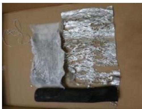
圖四十五 運轉 10 小時後的備長炭 A-11
