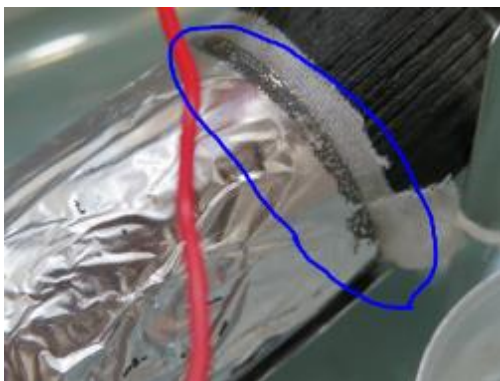
圖三十六 包裹在紗布巾上的鋁箔被侵蝕的孔洞和紗布巾的紋路一樣
