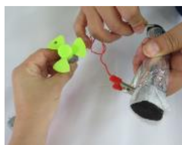
圖十 備長炭 B 製成的鋁空氣電池無法讓風扇馬達運轉起來
