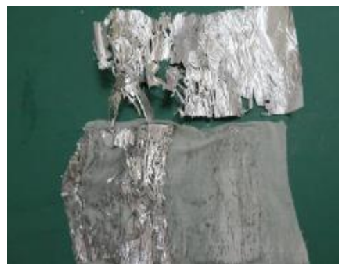
圖三十七 運轉 320 分鐘後的鋁箔侵蝕狀況嚴重
