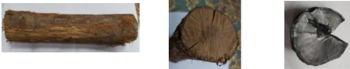
圖三十八 本次實驗使用的備長炭由烏桐櫟燒製而成，橫切面紋路呈放射狀
