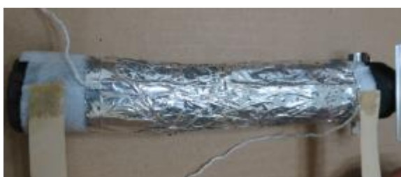
圖四十二 A-11 雙倍紙巾加補水設計
