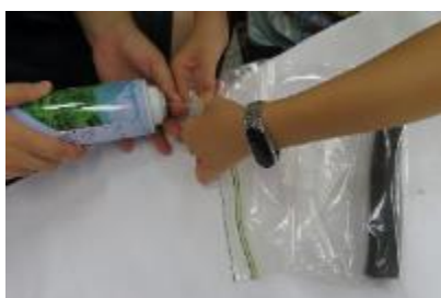
圖十六 袋密封袋注入氧氣，讓備長炭浸泡在氧氣中一小時
