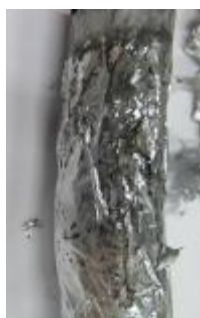
圖二十一 鋁箔上佈滿侵蝕的孔洞
