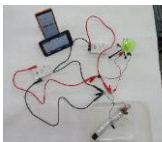
圖三十一 鋁空氣電池持續補水改良實驗設計
