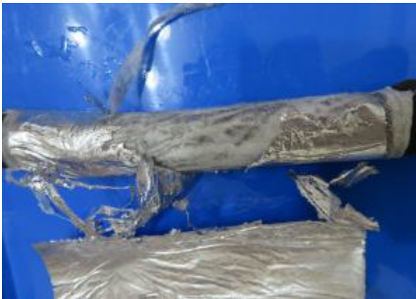
圖二十六 運轉 150 分鐘後的鋁箔上布滿被侵蝕的孔洞
