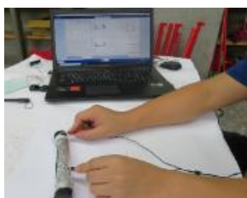
圖八-1 製成的鋁空氣電池利用 PASCO 電壓偵測器測電壓
