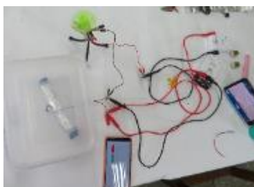
圖十七 將浸泡氧氣的鋁空氣電池放在盒中做實驗觀察
