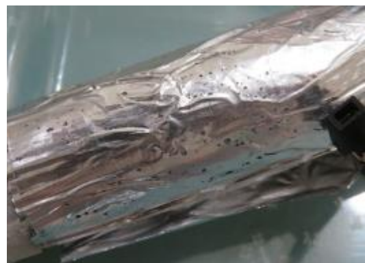
圖三十五 鋁箔上布滿被侵蝕的孔洞
