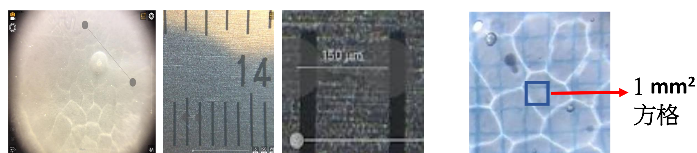
圖四：microPeek顯示之比例尺與游標 圖五：1 mm 2 方格紙用來尺的比對式校正，150 μm → 1 mm。量測結構紋路的面積大小
