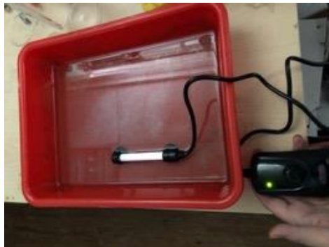
圖 4-2、使用電子溫控劑控制水溫
