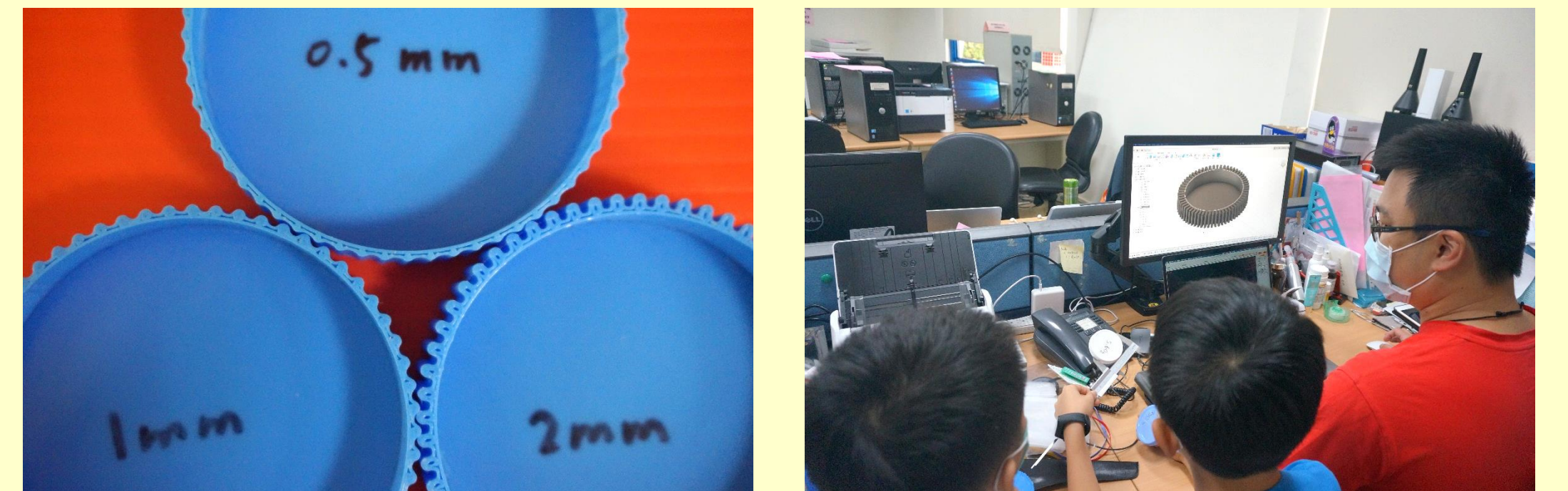
圖4-4-1：3D列印不同盤緣深度塑膠蓋
