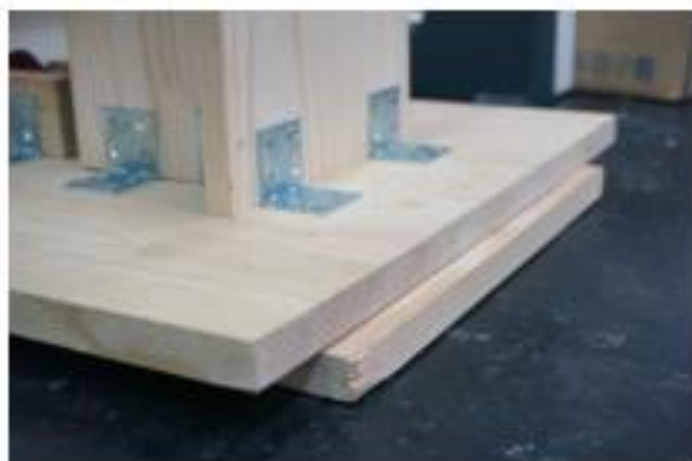
圖 4-7-2：利用木梯墊高來調整攻角的角度。
