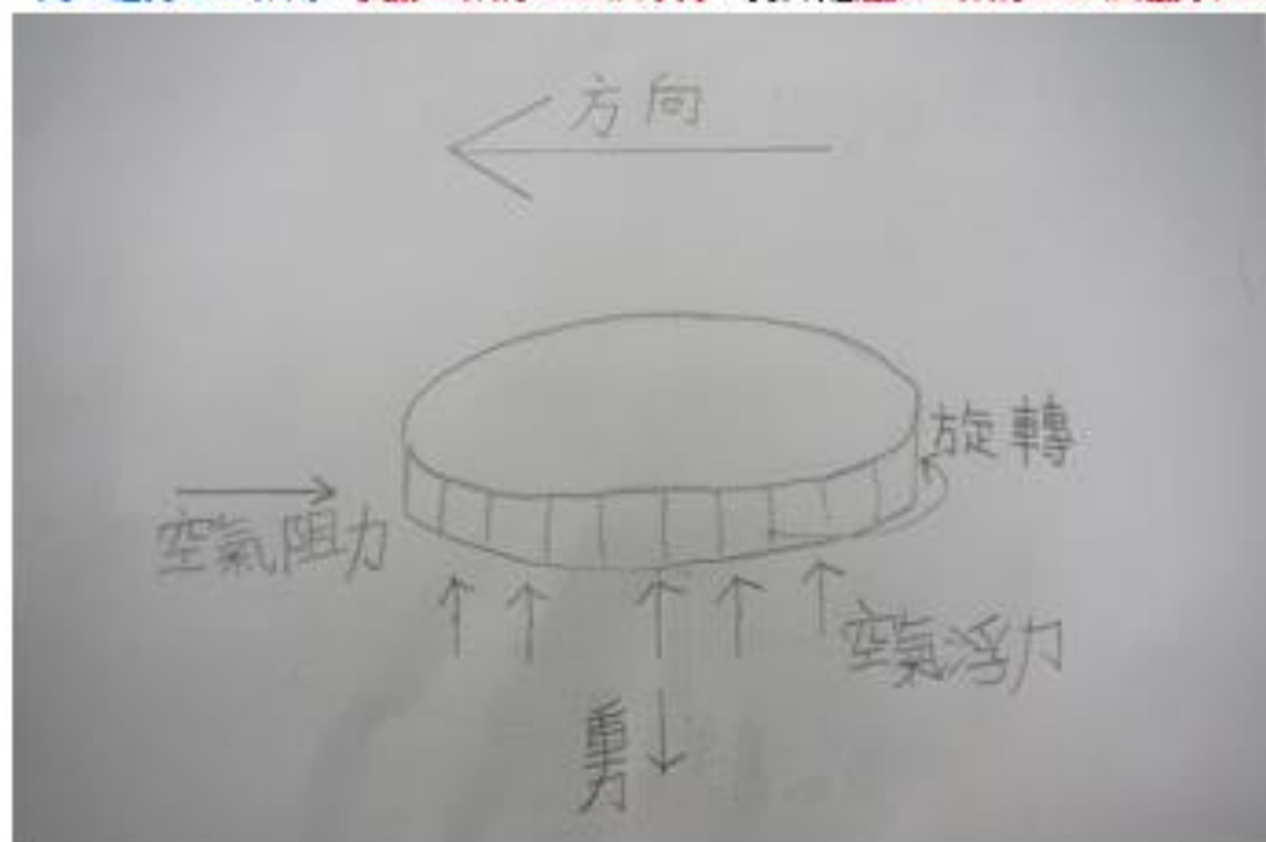
圖 4-5-1：塑膠蓋飛行的受力分析圖。
