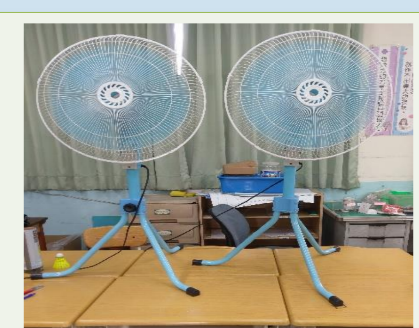
由於單一電扇用於側風的受風面積小，因此使用兩支電扇作為側風風源。
