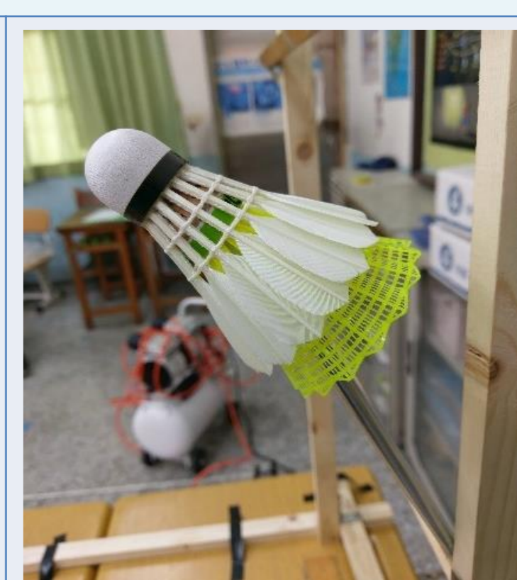
將要發射的羽球放置球托上，以仰角45°發射出去。
