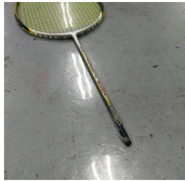
圖 11 第一支拍的中桿硬生生折斷，顯現彈力的強大。
