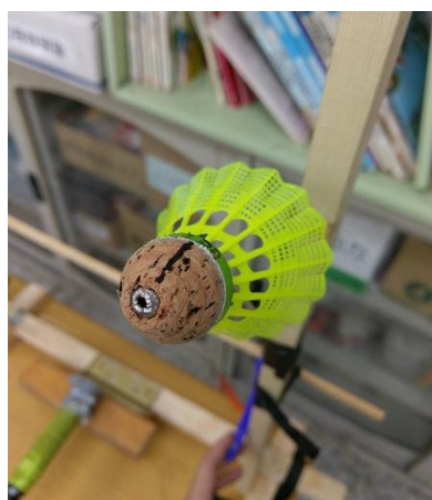
圖 14 塑膠球的球頭經塑型過，以鑽孔機穿孔，插在壓縮機的噴嘴上，作為球托。
