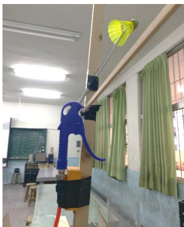
圖 13 將空壓機的噴槍固定於第一代發球機的木框上，使其仰角固定。
