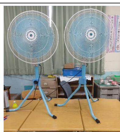
圖 21 由於單一電扇用於側風的受風面積小，因此使用兩支電扇作為側風風源。
