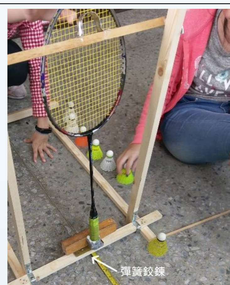
放開後，球拍因彈簧鉸鍊的彈力而揮頭向前，擊中置球架上的羽球球頭。
