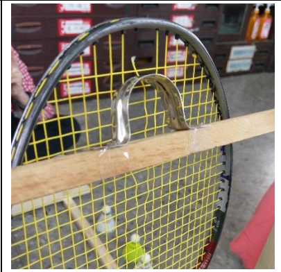
圖 12 第二支球拍的拍線被白鐵材質的置球架給割斷
