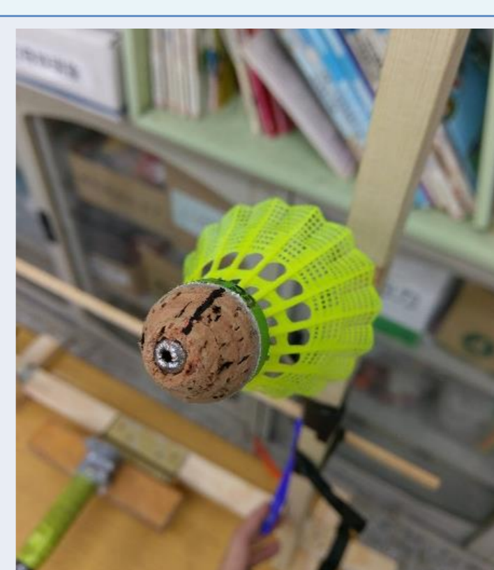
塑膠球的球頭經塑型過，以鑽孔機穿孔，插在壓縮機的噴嘴上，作為球托。
