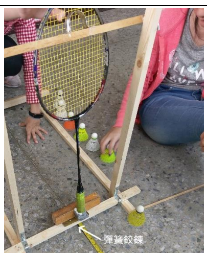
圖 8 放開後，球拍因彈簧鉸鍊的彈力而揮頭向前，擊中置球架上的羽球球頭。
