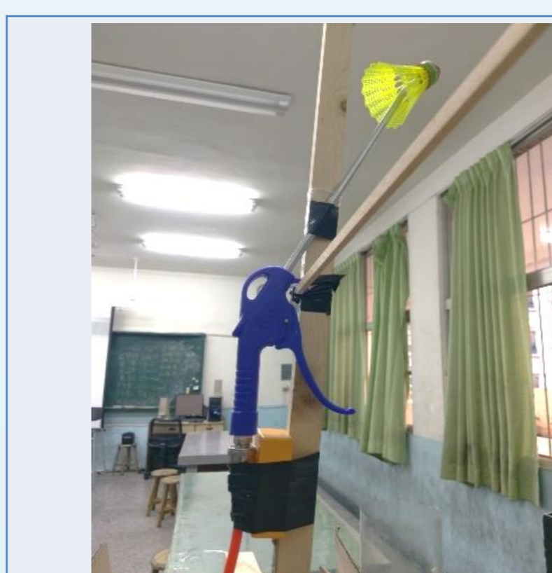
將空壓機的噴槍固定於第一代發球機的木框上，使其仰角固定。
