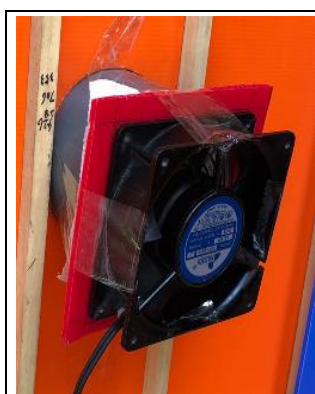
圖 4-12-1 煙囪底部加裝風扇
