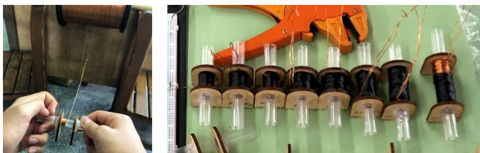
圖 4-5：(左)手工纏繞螺線圈；(右)螺線圈組示意圖
