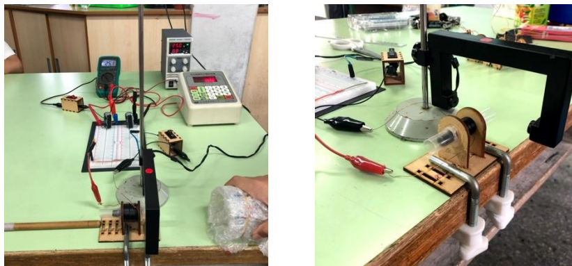
圖 4-9：(左)測量子彈發射速度裝置；(右)光電閘設置在螺線圈出口處
