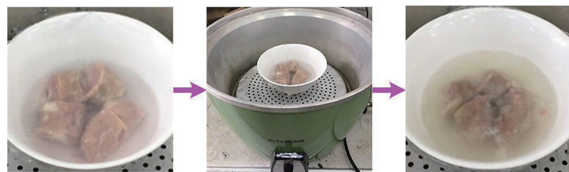
圖28 以「自製新型保鮮膜」包覆於容器上利用電鍋蒸煮加熱測試
