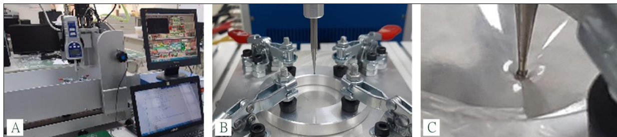
圖20. 以自製物性測定儀(CNC+推拉力計)進行穿刺試驗
