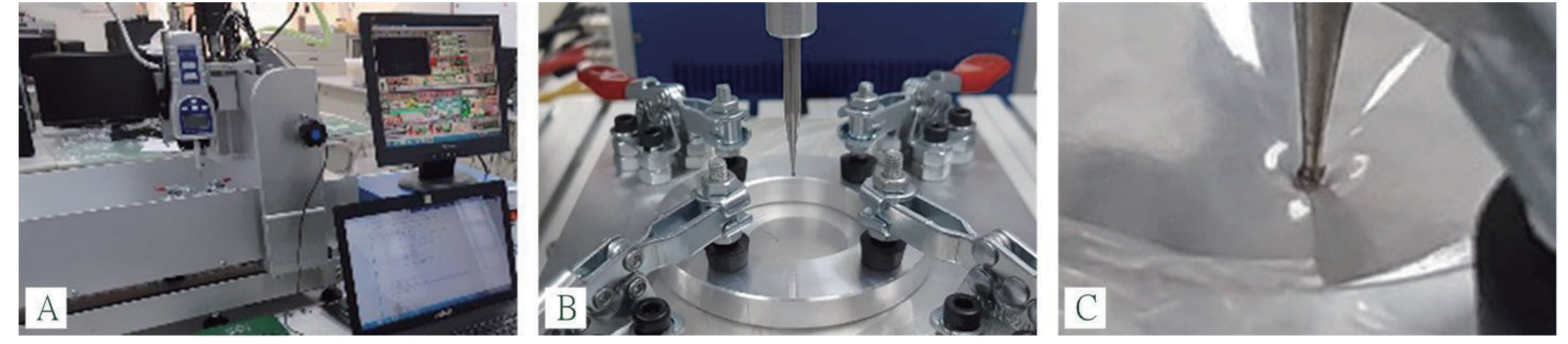
圖15. 以自製物性測定儀(CNC+推拉力計)進行穿刺試驗
