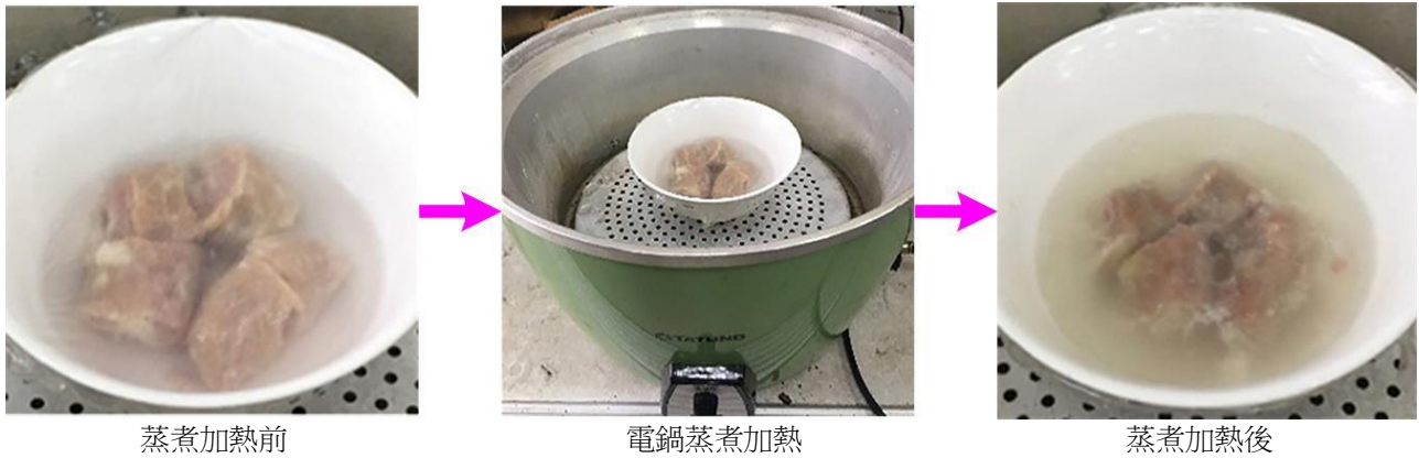
圖30. 以「自製新型保鮮膜」包覆於容器上利用電鍋蒸煮加熱測試
