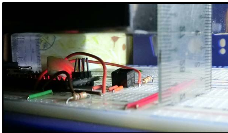
【圖十八】CNY70 測量距離兩公分的黑色平面
