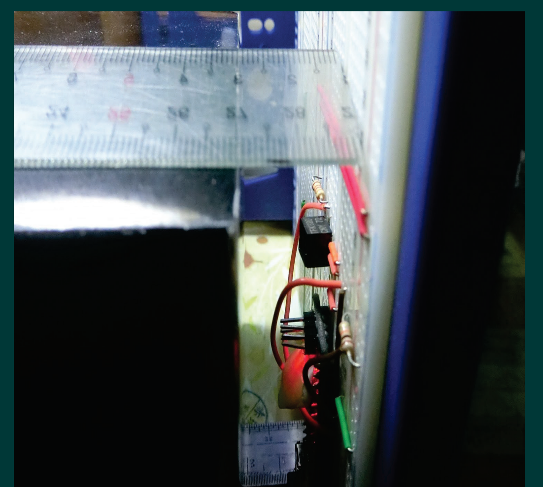
(圖五)CNY70 測量距離兩公分的黑色平面
