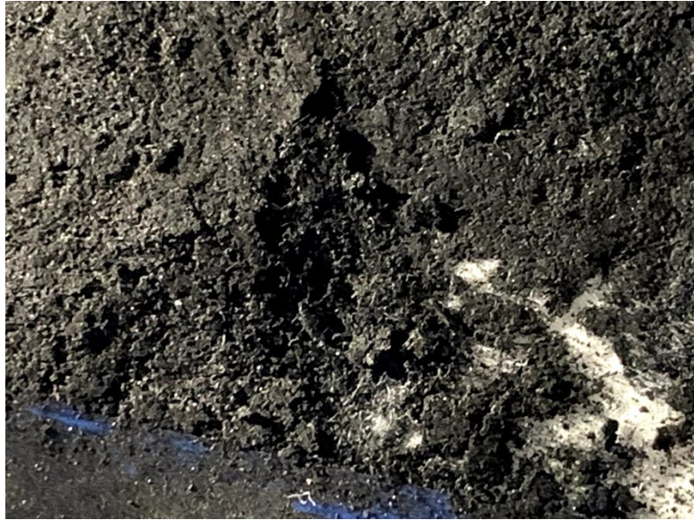
圖廿二、高 RGO 濃度多孔性石墨烯電極表面放大圖
