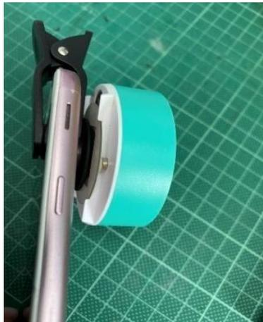
圖 5-a 高倍手機顯微鏡頭夾於手機上之側拍照。
