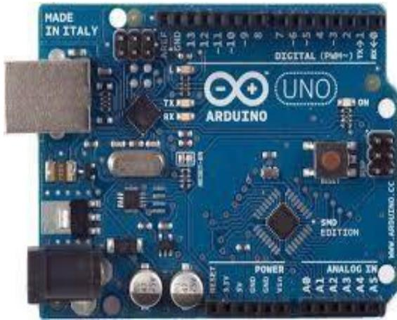
圖(20) Arduino UNO 板
