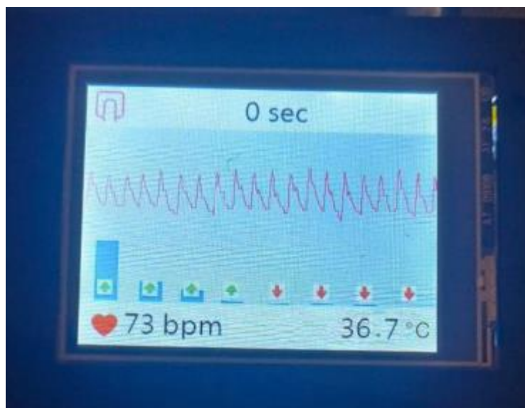
圖四十二、測量完畢後，左下方會顯示心跳數，可跟小米手環等做驗證。中央顯示傅立葉分析後的頻譜峰值能量大小，箭頭是量測過程中頻譜變化趨勢。右下角則是檢測體溫的顯示。
