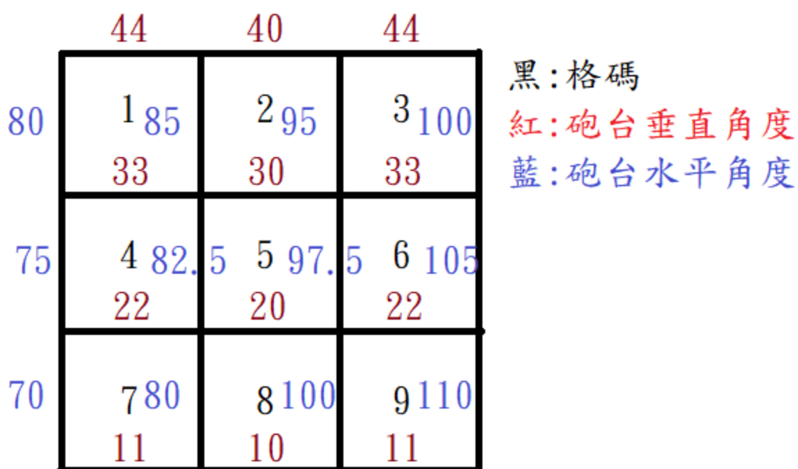
圖 11 圖形化九宮格垂直面之著彈點及砲口範圍測量
