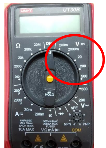
電表無法承受上千伏特的電壓
