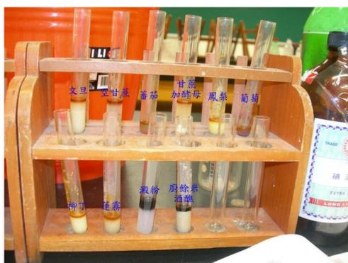
圖14、碘液之實驗檢測結果。
