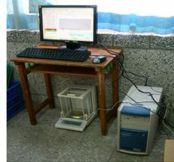
圖2、使用電子天平計量。
