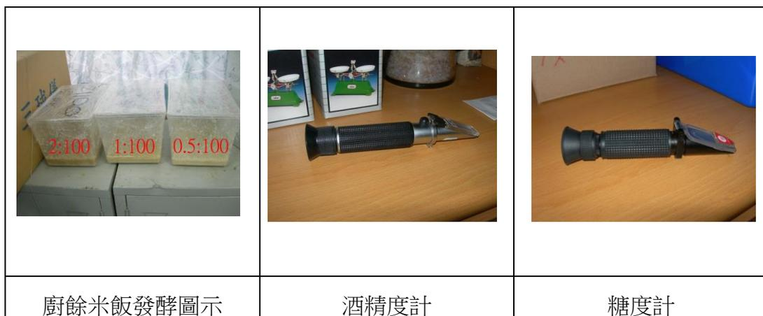
圖 4、廚餘米飯發酵及測量工具實驗圖示。
