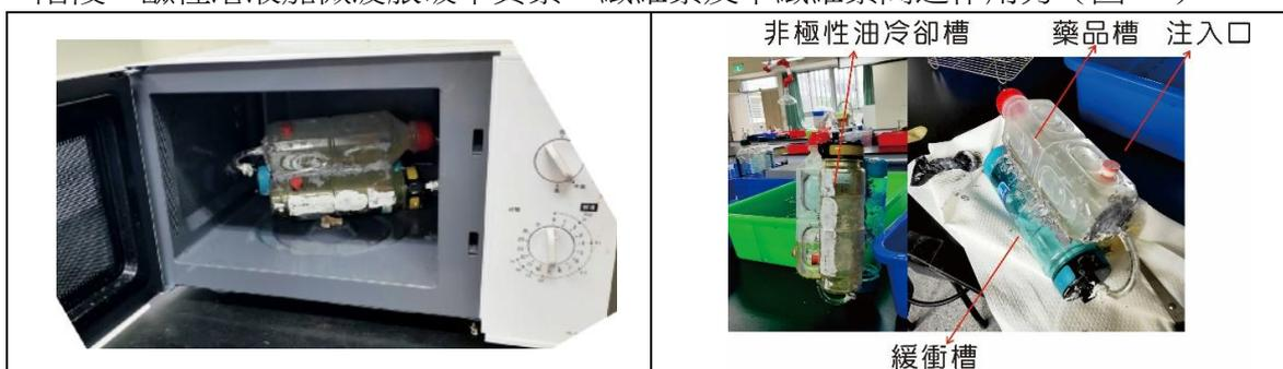
圖 41、鹼性溶液加微波水解槽裝置圖。
