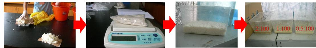
圖6、廚餘酒精探討探討酵母菌與米飯之比例實驗圖示。
