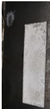
▲圖十九：用抽風櫥抽乾的矽烷修飾二氧化鈦塗層
