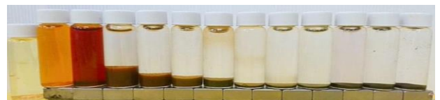
pH 1 2 3 4 5 6 7 8 9 10 11 12 13 【圖】以 \text{FeSO}_4 為前驅物合成 \text{Fe}_3\text{O}_4 在不同 pH 下的沉澱物完全靜置沉降後
