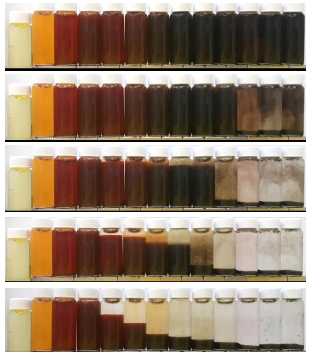
pH 1 2 3 4 5 6 7 8 9 10 11 12 13 【圖】以 \text{FeSO}_4 為前驅物合成 \text{Fe}_3\text{O}_4 在不同 pH 下的沉澱物外觀及磁性
