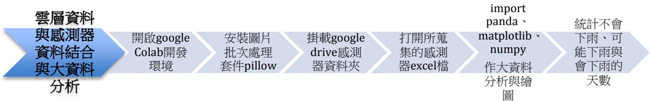
2. 將雲層圖片大小做尺寸的轉換，由原來的圖片大小解析度為 1640x1232，轉換為 256x256。此步驟的目的是為了讓電腦可以進行讀取，同時又降低運算的複雜度。
