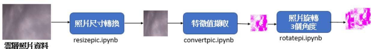
圖二十一:大氣感測器資料與雲層圖片的處理程序
