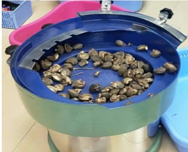
圖 26. 變頻式變壓器震動送料機
