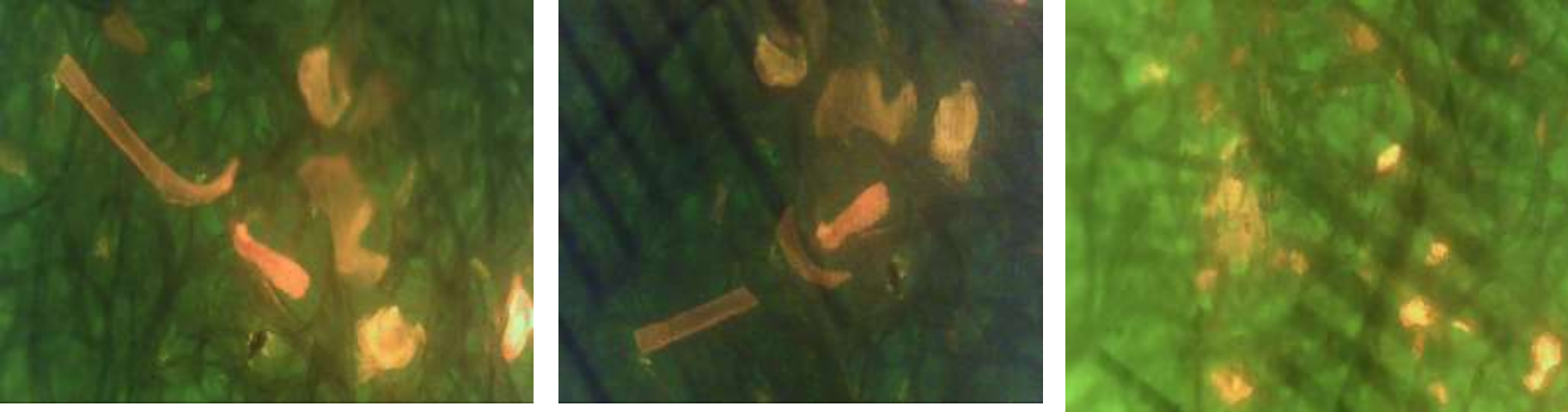
圖18. 由左至右為針筒削片、巢和紅蟲體內的塑膠微粒圖
