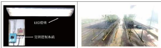
圖7. 光照控制裝置與溫室(本研究設計製作)
